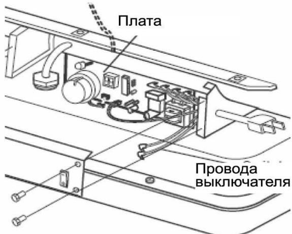
Для моделей QE-40D, QE-70D, QE-120D: обслуживание — аналогично моделям QE-15D, QE-25D. Для замены — снимите боковую крышку возле выключателя. Отсоедините провода от выключателя и снимите крышку. Отсоедините провода фотоэлемента от платы и выньте фотоэлемент. Установите новый фотоэлемент и соберите нагреватель в обратном порядке.
