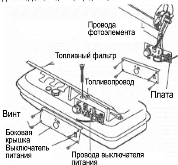
Снять боковую крышку, отсоединить топливопровод от топливного фильтра. Повернуть топливный фильтр против часовой стрелки на 90°, потянуть его на себя и вынуть. Промыть фильтр керосином и установить обратно. Присоединить топливопровод и установить обратно боковую крышку.
