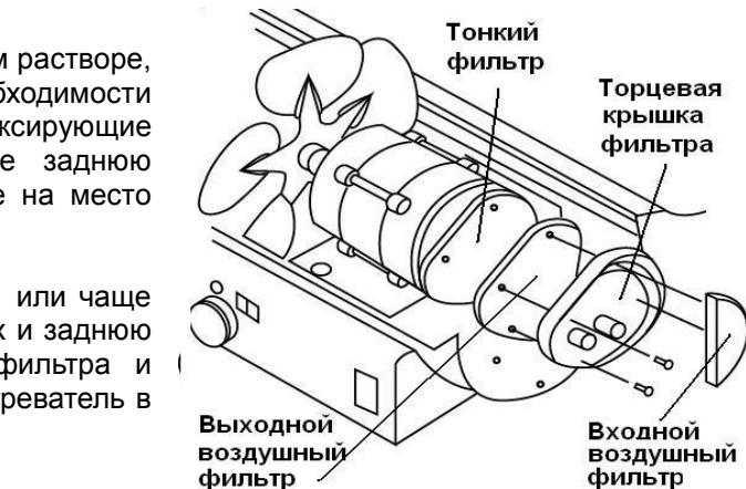
Очищать по мере необходимости, но не реже 1 раза в год. Снимите верхний кожух. Ослабьте винт, удерживающий лопасти на валу и снимите лопасти. Очистите лопасти вентилятора мягкой тканью смоченной в керосине или растворителе. Просушите лопасти и установите обратно на вал. Закрутите плотно винт, установите верхний кожух. При несвоевременной очистке лопастей, появляется дисбаланс вентилятора, что приводит к выходу из строя вентилятора.
